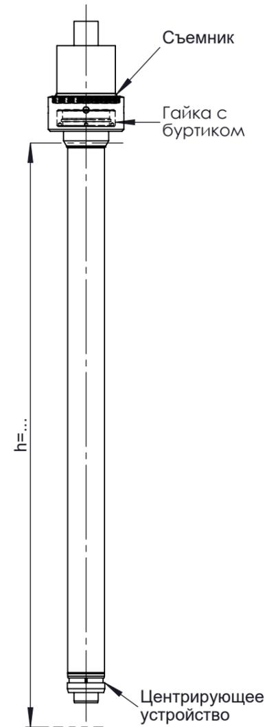
Испытание охватываемой детали
